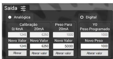
Para realizar o ajuste da saída digital, o operador deve alterar o valor "Novo Peso" para o peso qual ele deseja que a saída ligue. Por exemplo, se colocar 1000g, quando o peso alcançar ou ultrapassar o valor de 1000g a saída é acionada. Quando o peso diminuir e for menor do que 1000g, a saída é desacionada.
